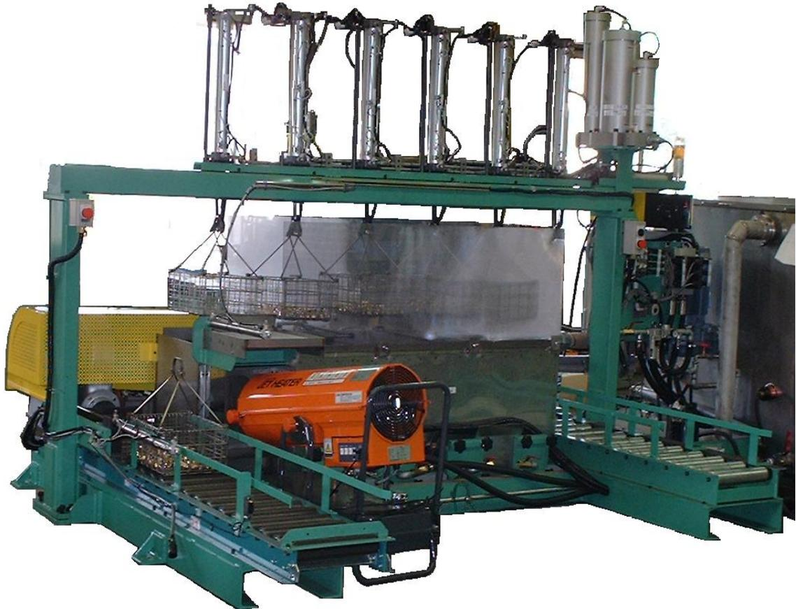
本機 超音波洗浄乾燥機は切削加工部品等の脱脂、洗浄を温水（冷水）にて行う自動洗浄仕様になっており、高温洗浄の場合には、溶剤を使用せずに洗浄効果が高く、環境問題にも優しい機器となっております。
